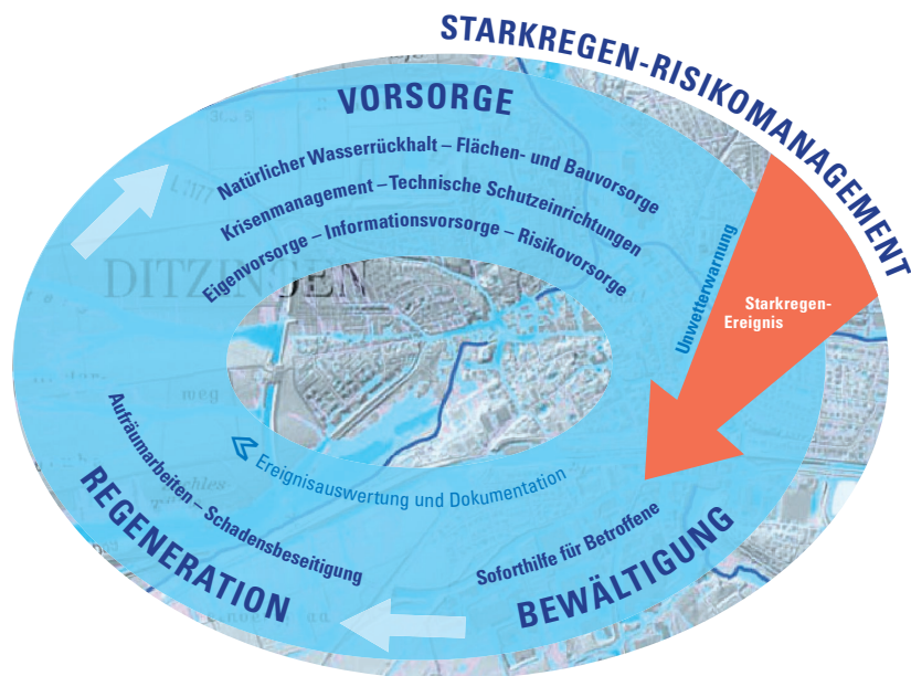
Abbildung 1: Handlungsfelder im Starkregenrisikomanagement (überarbeitet nach WBW, 2012)
