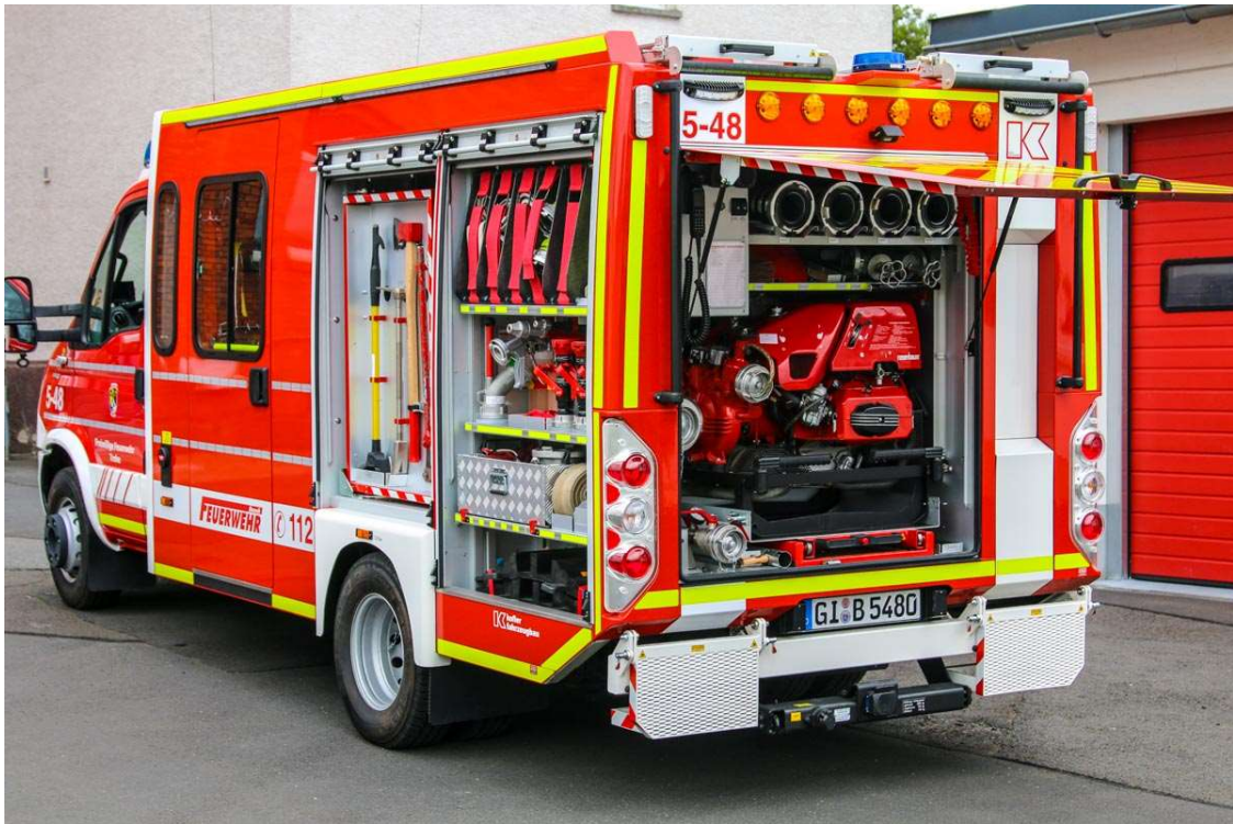
Abbildung 15: Symbolbild eines TSF-W mit zulässiger Gesamtmasse von 6,8 t der Feuerwehr Buseck - Abteilung Trohe (Quelle: Kofler Fahrzeugbau).
